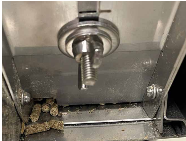
Kleine Pellets dosiert dieser Automat durch eine „Erbsenöffnung“, um Verschwendung vorzubeugen.
