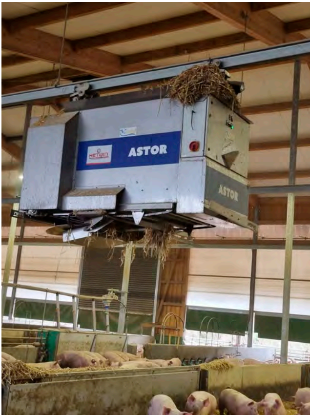
Bild 3: Der Einstreuroboter fährt über die Mastbuchten
