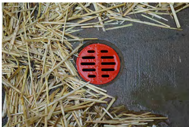
Die Abschlussdeckel sind befahrbar und für eine Punktbelastung von 600 kg konstruiert. Die definierte Schlitzbreite beträgt 8 mm.
