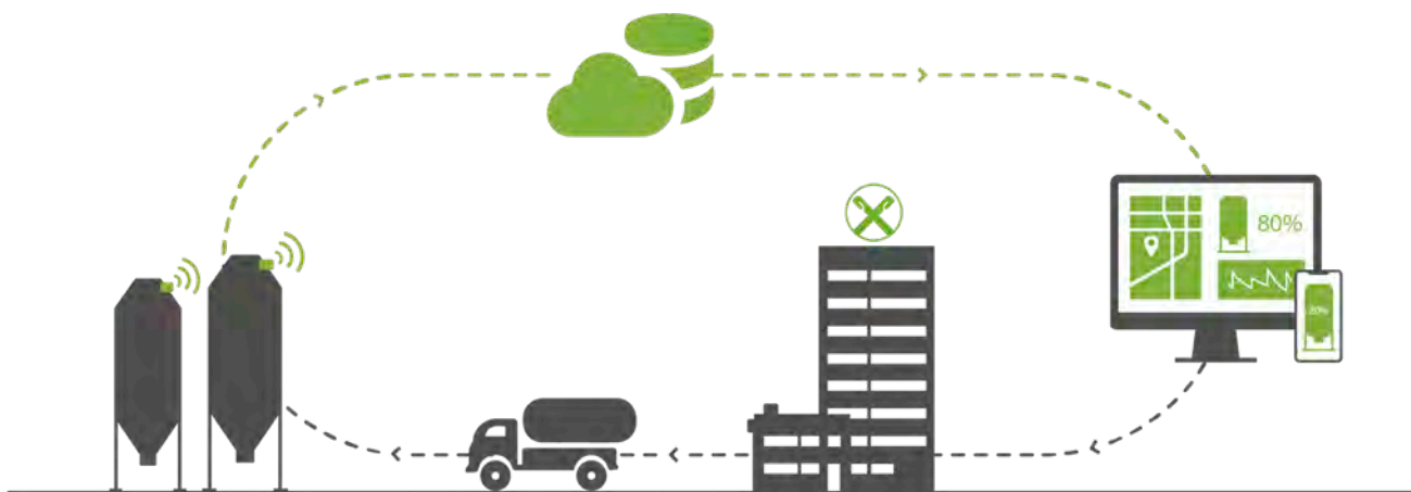
Sensor RSilo misst Füllstände im Futtermittelsilo
