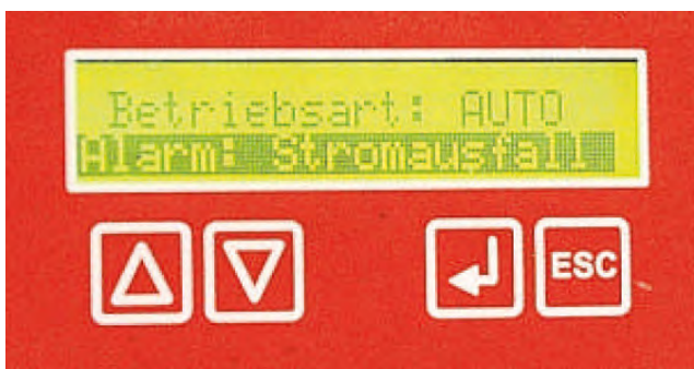
Wenn die Alarmanlage bei Stromausfall meldet, kann der Landwirt reagieren, ehe es heiß wird im Stall.
