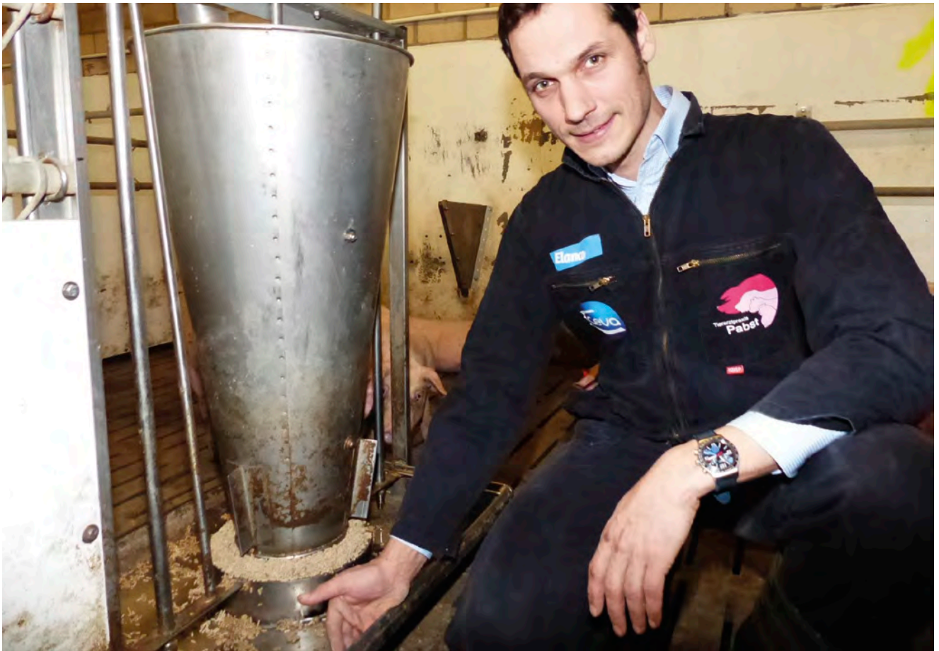
Die Kante innen im Trog reduziert die technischen Futterverluste deutlich. Quelle: Landwirtschaftliches Wochenblatt
