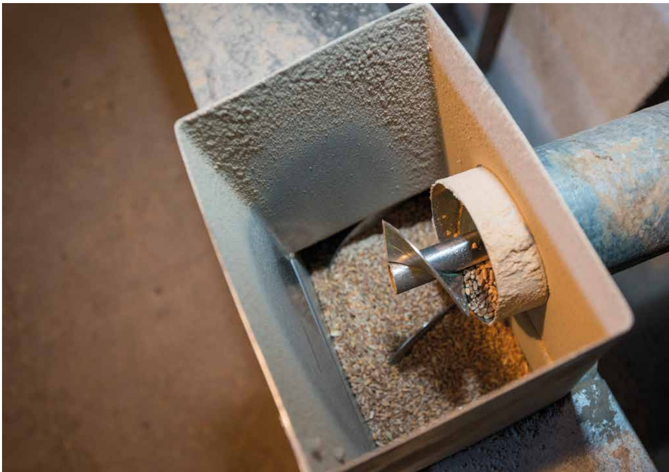
Lagert Getreide in verschiedenen Silos, ist es sinnvoll, es über Siloschnecken in eine Trogschnecke zu fördern.
