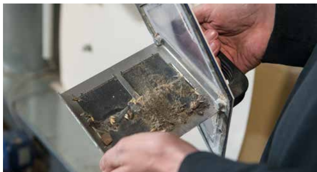
Ein Magnet fängt Eisenteile vor den Sieben ab. Auch Halmteile und Schmutz sammeln sich, sodass er regelmäßig gereinigt werden muss.
