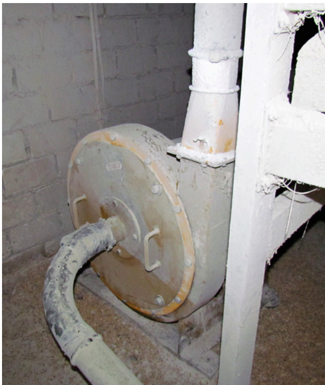
Diese Gebläsemühle wird im Rahmen einer systemischen Optimierung durch eine gebläselose Mühle ersetzt.
